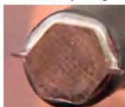
Over Crimped Lug
